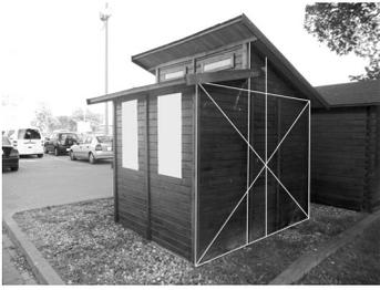
Die Senkrechten eines Objektes werden hier erst einmal immer Senkrecht gezeichnet. Der obere und untere Endpunkt dieser Senkrechten wird immer zu beiden Seiten zu den Fluchtpunkten hin verbunden.
