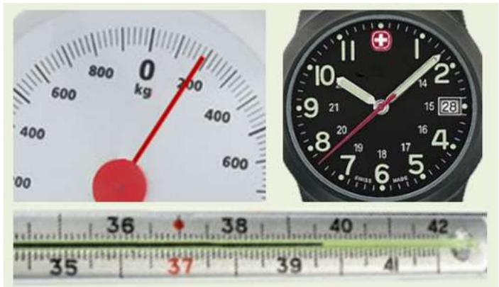
Küchenwaage oder Armbanduhr. In einem analogen Thermometer befindet sich ein schmales Glasröhrchen, das mit gefärbtem Alkohol gefüllt ist. Der Alkohol dehnt sich bei Temperaturerhöhung aus, das heißt, der Flüssigkeitsspiegel bzw. die Flüssigkeitssäule im Röhrchen steigt an. An einer Zahlenskala kannst du ablesen, welcher Temperatur die Ausdehnung der Flüssigkeit entspricht. Alle diese Geräte haben innerhalb eines bestimmten Messbereichs die Möglichkeit, unendlich viele Signale anzuzeigen.
