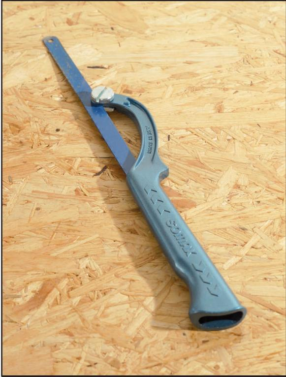
Diese Säge hat den Vorteil, dass man lange Schnitte im Blech machen kann, ohne dass der Bügel stört. Desweiteren werden in dieser Säge handelsübliche Metallsägeblätter verwendet.
