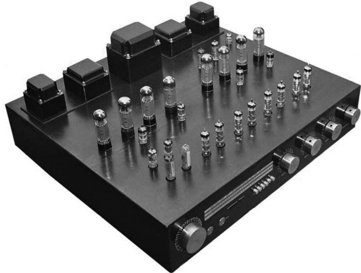
Abb. 2: modernes UKW-Röhrenradio mit 28 Röhren
