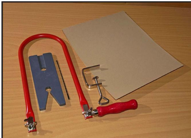
Beim Kauf ist auf den richtigen Verwendungszweck zu achten, es gibt unterschiedliches Schleifpapier speziell für Metall, Holz und Farbentfernung. Die Körnungen sind auf der Rückseite aufgedruckt, sodass man auch weiß, welches gerade benutzt wird.
