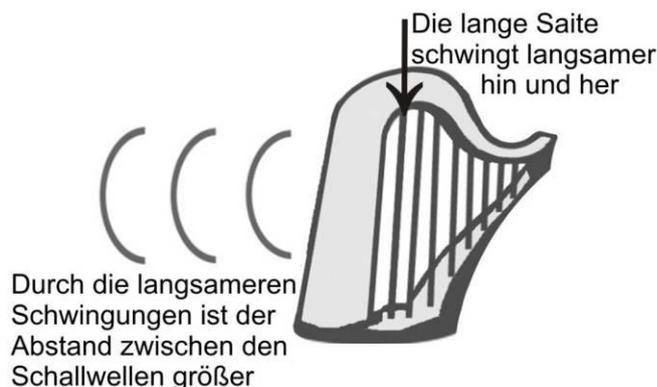
Die Zahl der Schwingungen, die eine Schallquelle in einer Sekunde macht, nennt man die „Frequenz“, und die Maßeinheit für die Frequenz ist „Hertz“. Der Abstand zwischen zwei einzelnen Wellenspitzen der Schallwelle heißt „Wellenlänge“. Die Höhe der Welle ist die Amplitude. Sie gibt an, wie die Lautstärke ist: je höher die Amplitude, umso lauter ist der Ton, der Klang, das Geräusch oder der Knall.
