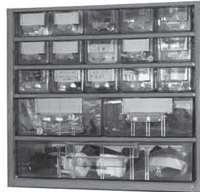
Für die Widerstände wird jeweils der erste Farbring notiert: Widerstände braun, Widerstände rot usw.. Für Kondensatoren und für Elkos gibt es je ein Schubladchen, auch für Dioden, LEDs, Einstellwiderstände, Heißleiter usw..
