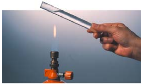
2 Wasser ist ein schlechter Wärmeleiter. Während das Wasser in dem oberem Bereich siedet, merkt man an der Hand kaum eine Erwärmung.
