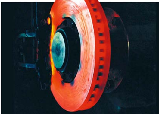
1 Bremsscheiben eines Pkw erreichen bei Belastung eine Temperatur von bis zu 600 °C.
