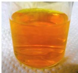
Zu 10 ml Wasser wird in einem Schnappdeckelglas (oder Reagenzglas) ein Spatel Kaliumbromid gegeben. Schütteln, bis sich das Bromid gelöst hat. Die Lösung wird anschließend mit ca. 2 ml Chlorbleichlauge (Natriumhypochloritlösung) versetzt. Danach wird so viel konzentrierte Schwefelsäure zugetropft, bis eine deutlich orangene Lösung entstanden ist. Das Glas wird sofort verschlossen. Die Lösung sollte nicht aufbewahrt werden, da das Bromwasser unter Lichteinwirkung allmählich zerfällt.
